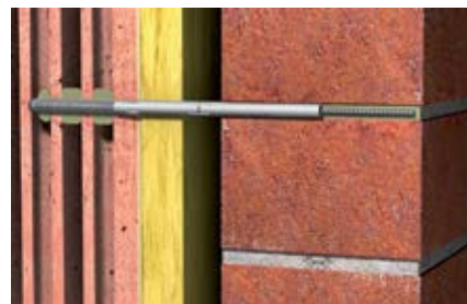
Фрагмент: Ремонт облицовки
