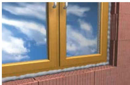
Швы оконных проемов
