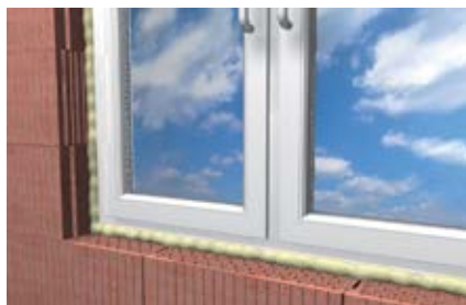
Швы оконных соединений
