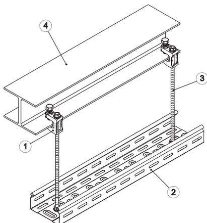
Струбцина (1) фиксируется на несущих металлоконструкциях (4) путем затягивания болта и контргайки, входящих в комплект. Шпилька (3) для подвеса Лотка (2) продевается в отверстие Струбцины (1) и фиксируется на определенной высоте двумя отдельными Гайками в верхней части струбцины.
