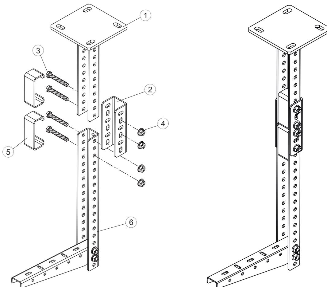
К Стойке потолочной сварной (1) сзади накладывается Соединитель стойки (2). Верхнее отверстие боковой перфорации Соединителя стойки (2) соединяется с третьим отверстием снизу у Стойки потолочной сварной (1) через Болты (3).
