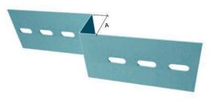
Используется для выполнения переходного соединения по ширине. Подходит к лоткам с высотой борта: 50, 70, 100мм. Материал: Сталь оцинкованная по методу Сендзимира. Вариант исполнения: Порошковая окраска по цветам RAL. Вариант исполнения: Горячая оцинковка.
