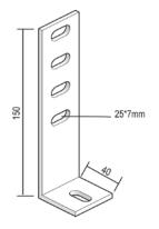
Используется для вертикального монтажа кабельных лотков лестничного типа.
