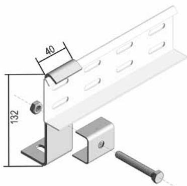
Для вертикального монтажа кабельных лотков лестничного типа.
