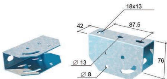
Необходима для монтажа сборной потолочной стойки на базе профиля UP.
