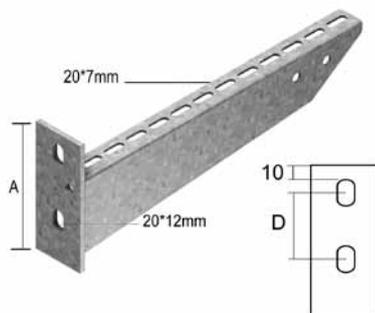
Для крепления непосредственно на стену и к потолочным стойкам
