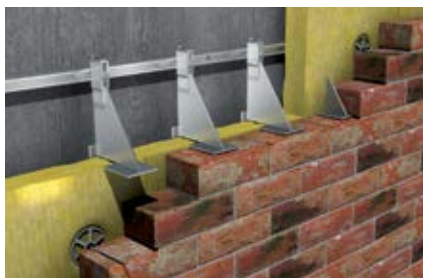
Термоизоляционные материалы в двухслойных наружных стеновых панелях
