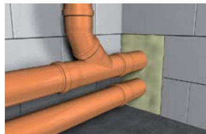
Заделка сквозных отверстий при монтаже трубопроводов
