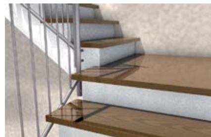
Лестничные ступени на бетонных лестничных балках
